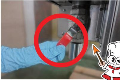
油槽内に手を入れ清掃する場合は、必ずコンベアを停止します。停止が確認できたら、排油レバーを開けます。火災、火傷やケガを防ぐためにも、排油後は必ずレバーを戻し、閉じましょう。
