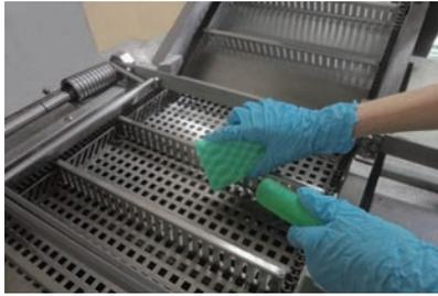
お手入れの際には、中性洗剤を使用してください。スポンジ等で油槽内をこすり、汚れを落としてください。完了後、油槽内の水気を完全に拭き取りましょう。
