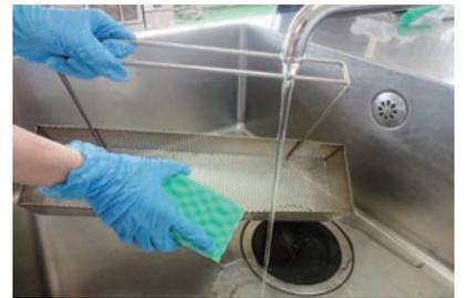
すべり板・揚げカス受けバスケット等の付属品の汚れを中性洗剤で十分洗い流してください。清掃後は、よく水を切ってから元の位置に正しく取り付けてください。
