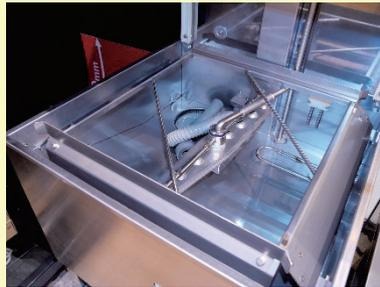
清掃後は雑菌の繁殖・悪臭の発生を防ぐために洗浄ドアを開き、内部を乾燥させてください。
