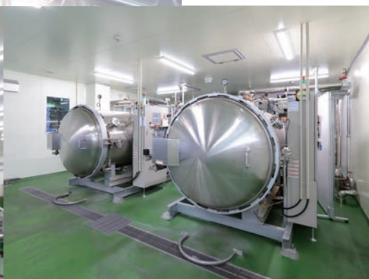
真空調理、ストックバックの様々な設備。注入作業は刻み・ペーストなどの形態、食材により力加減が微妙に変わる（上）。真空バックは一気に大量に加圧、殺菌される（下右）。
