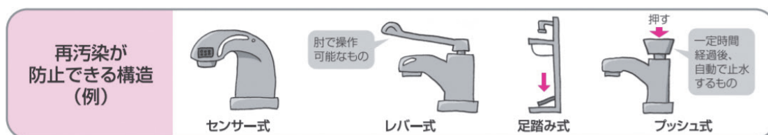
図1 再汚染が防止できる構造（例）
